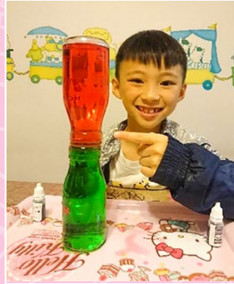
第二部分結果：可以看到紅色熱水並沒和綠色冷水混合，而是界線分明的保持靜止。
